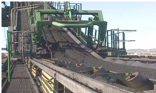
图2 尾车皮带边缘松弛而造成撒料
